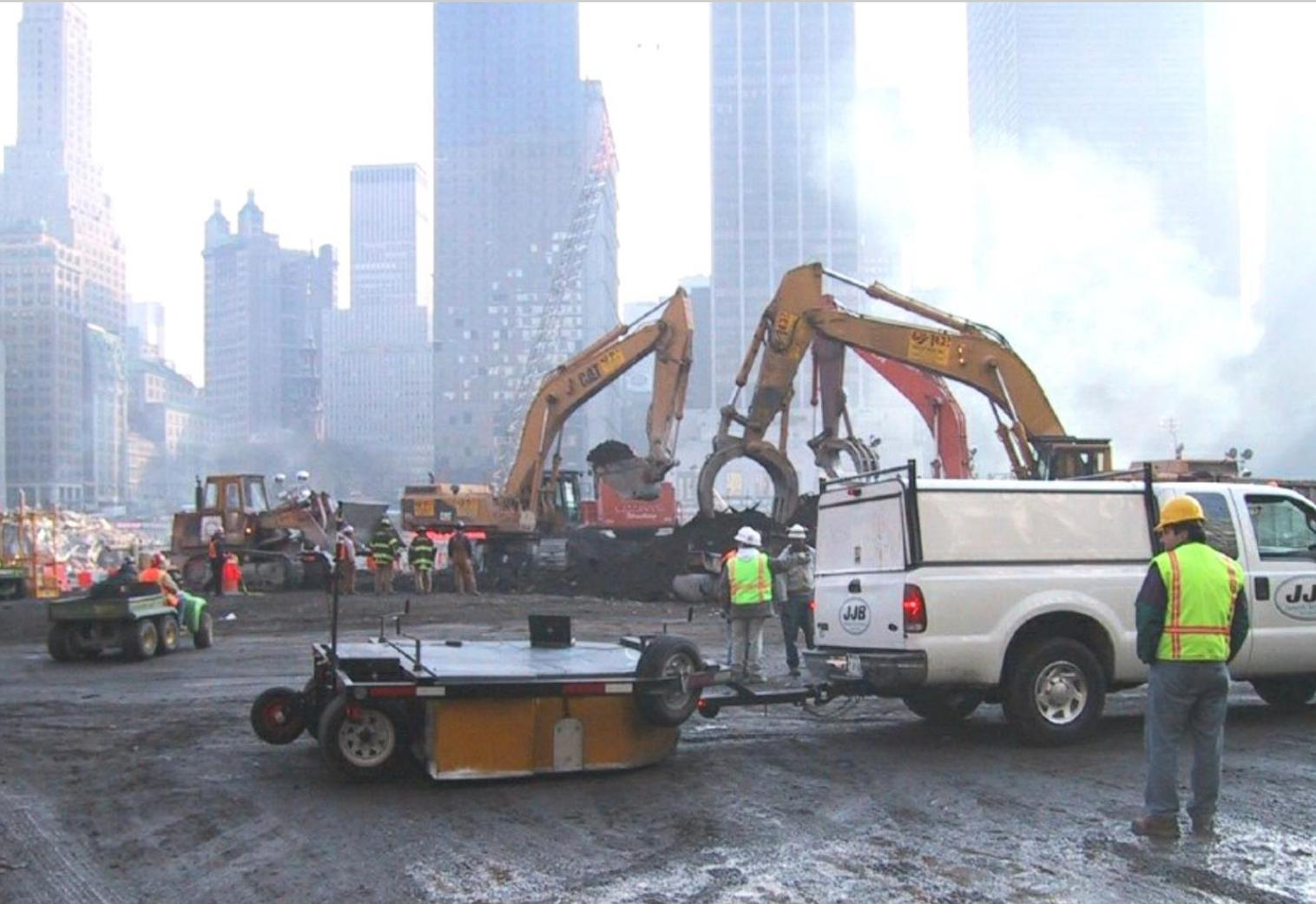
Sistema radar multicanale per la mappatura dei sottoservizi. Il carrello montato in coda al veicolo contiene un array di 17 antenne. Con un solo profilo si ottengono dati su una larghezza di circa 2 metri. E' possibile ricostruire posizione e geometria di tutte le tubature presenti nei primi 2 metri di sottosuolo.
