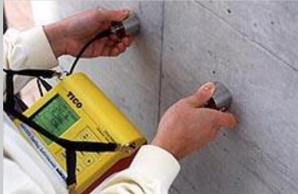
Sistema per indagini ultrasoniche. Due trasduttori piezoelettrici sono utilizzati come sorgente e come ricevitore. Dal tempo di volo del segnale si ricava la velocità del mezzo indagato e quindi si può controllare la qualità del calcestruzzo
